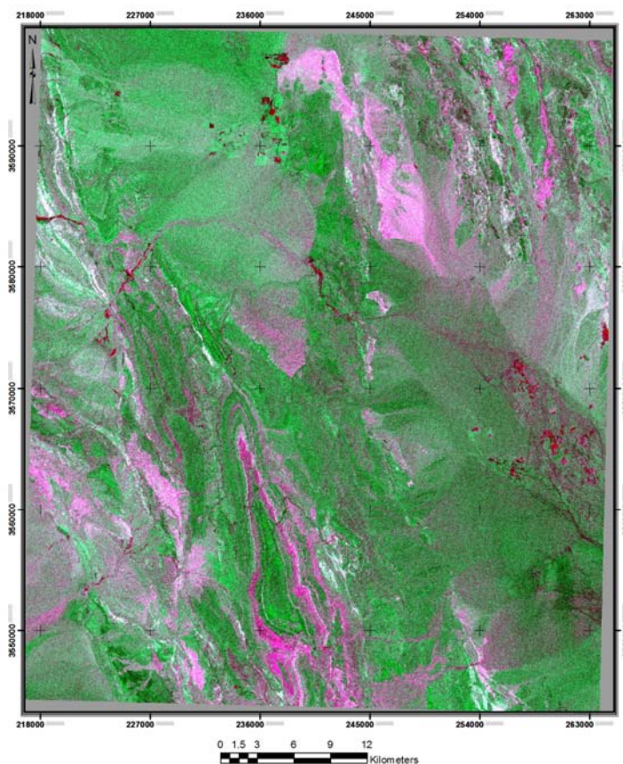
شکل (۷-۵) - نقشه دگرسانی حاصل از روش PCA با استفاده ترکیب رنگی (PC_4, PC_5, \frac{PC_4 + PC_5}{2}) که RGB: (PC_4, PC_5, \frac{PC_4 + PC_5}{2}) پیکسل های قرمز دگرسانی حاوی هیدروکسیل و پیکسل های سفید هر دو نوع دگرسانی را نشان می دهد.
