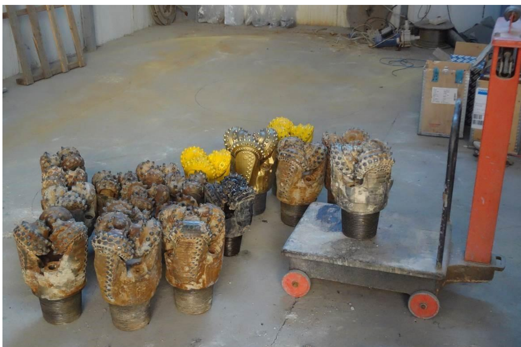
شکل ۴-۹- توزین سرمته‌های نو و مستهلک جهت تعیین میزان افت وزنی
