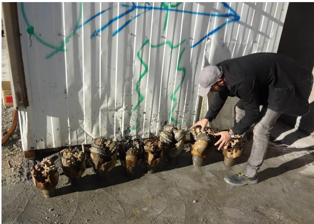
شکل ۴-۸- جمع‌آوری، شستشو و آماده‌سازی سرمته‌های مستهلک جهت انتقال به آزمایشگاه تحقیق و توسعه
