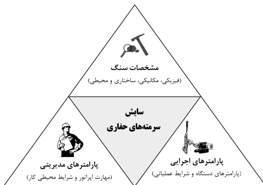
شکل ۲-۱۸- پارامترهای مؤثر در سایش سرمته‌های حفاری
