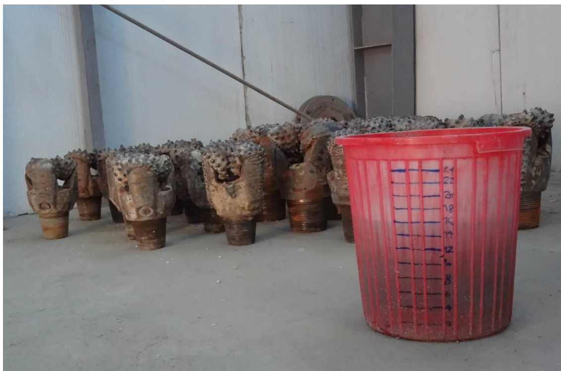
شکل ۴-۱۱- اندازه‌گیری افت حجمی سرته‌های نو و مستهلک با استفاده از سطل مدرج در ۱۶ لیتر آب
