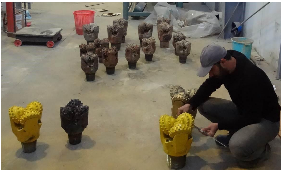
شکل ۴-۱۰- اندازه‌گیری ابعاد قطری، ارتفاعی و دندان‌های سرته‌های نو و مستهلک جهت تعیین میزان افت ابعادی همچنین برای تعیین افت حجمی، میزان تغییرات حجم آب در زمان قرار دادن سرته‌ی نو و مستهلک در ۱۶ لیتر آب برای سرته‌های مختلف اندازه‌گیری شده است (شکل ۴-۱۱).
