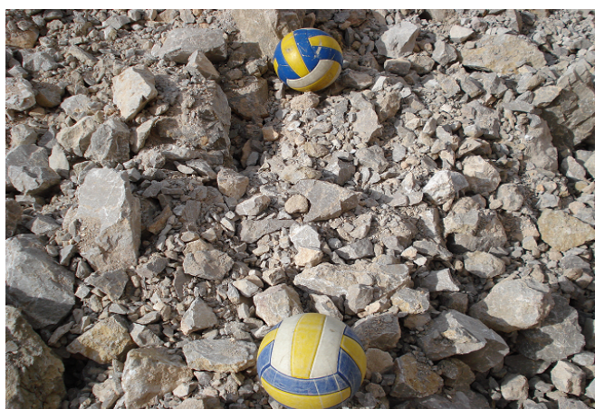
شکل ۳-۴ - قرار دادن اشیاء به عنوان مقیاس بر روی قطعات خرد شده در زمان عکسبرداری
