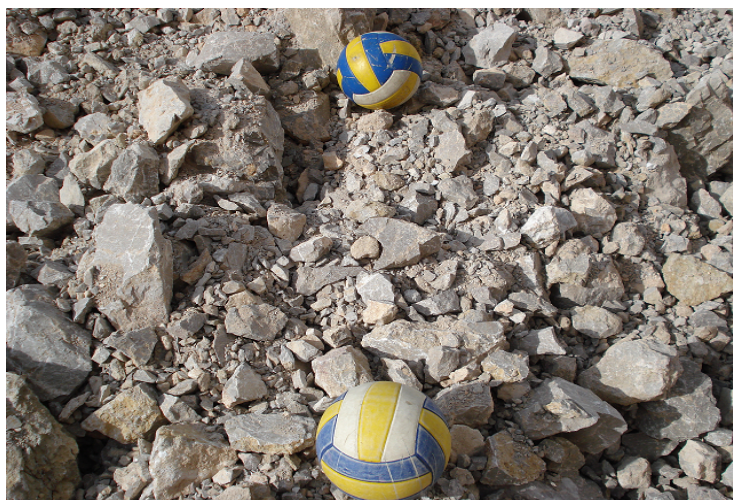
شکل ۴-۴- قرار دادن اشیاء بعنوان مقیاس بر روی قطعات خرد شده در زمان عکس‌برداری
