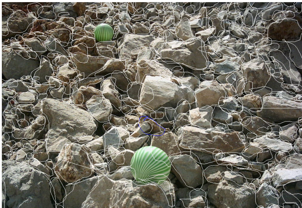
شکل ۴-۵- مرزبایی قطعات سنگی در نرم افزار Gold Size
