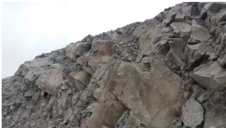
شکل 4-9 جهت یافتگی ناپیوستگی ها و آتشباری در خلاف جهت آن در معدن مس سونگون
