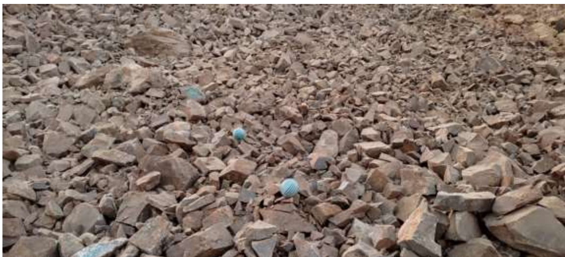
شکل 4-16 نمونه از کپه انفجاری مقیاس گذاری شده برای استفاده در نرم افزار Split-Desktop
