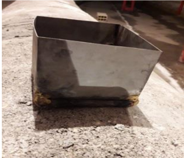
شکل ۳-۷: حوضچه حریق با ابعاد سطح ۱۰×۱۰ سانتی‌متری.
