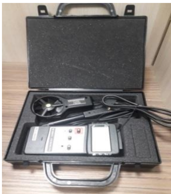
شکل ۱۱-۳: سرعت‌سنج جریان هوا.
