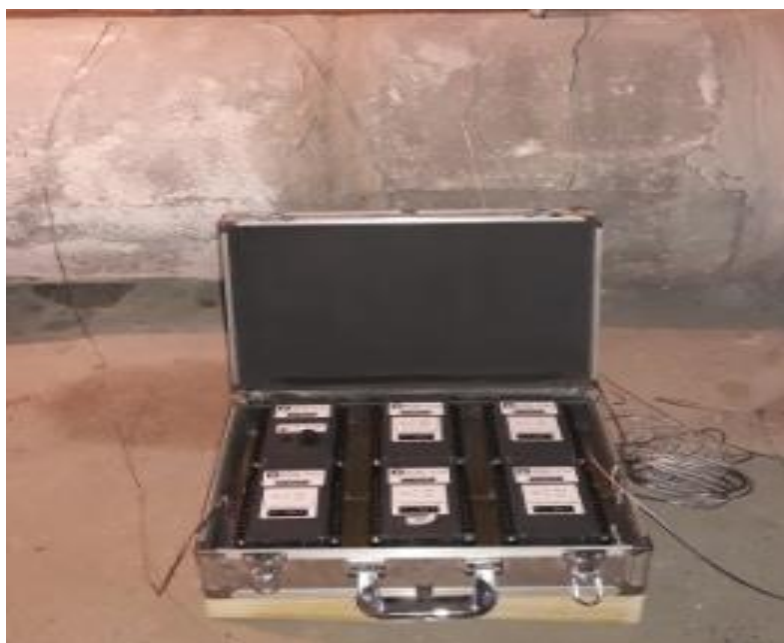
شکل ۳-۶: ثبات داده‌نگار ۶۴ کاناله.
