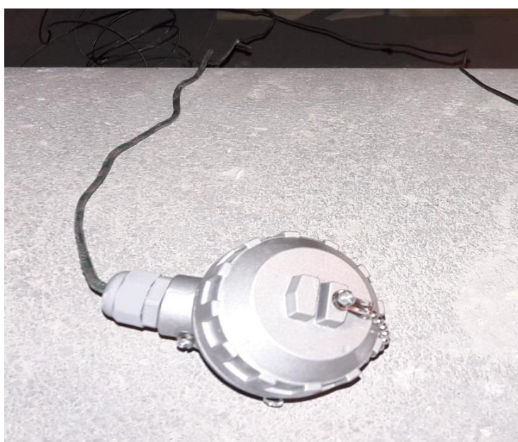
شکل ۳-۵: ترموکوپل نوع K استفاده شده در سقف تونل.
