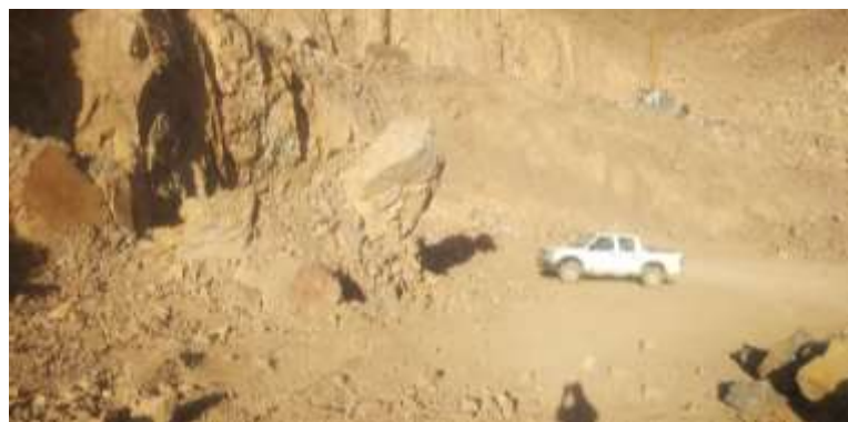
شکل ۳-۶ - وضعیت پاشنه، بولدر و خردایش نامناسب انفجارها
