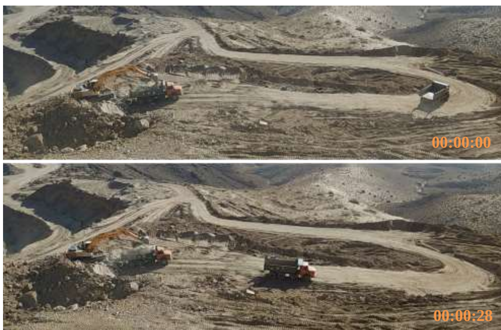
شکل ۳-۷- برداشت زمان یک سیکل بارگیری جام بارکننده
