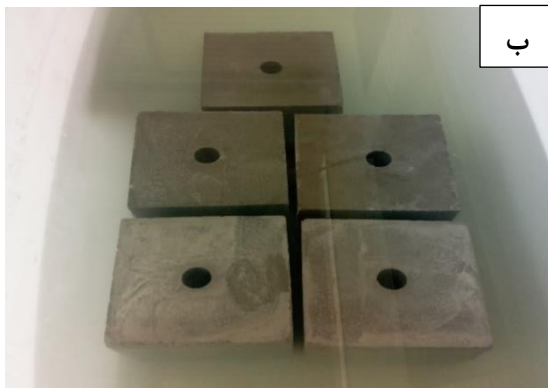
شکل ۲-۵) الف) بتن‌ریزی نمونه‌های مکعبی ب) قرار دادن در حوضچه آب
