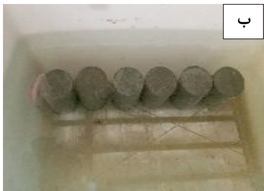
شکل ۴-۱ الف) بتن‌ریزی نمونه‌های استوانه‌ای، ب) قرار دادن نمونه‌ها در حوضچه آب
