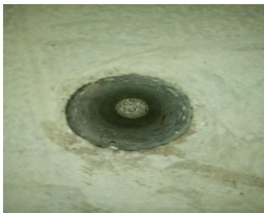
شکل ۵-۵) آب‌بندی انتهای حفره موجود در نمونه‌های مکعبی
