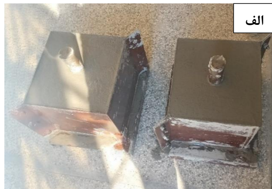
شکل ۲-۵) الف) بتن‌ریزی نمونه‌های مکعبی ب) قرار دادن در حوضچه آب
