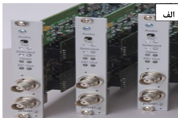
شکل ۴-۴) الف) ASIP-2 (پردازشگر سیگنال آکوستیک) [108]، ب) بدنه دستگاه
