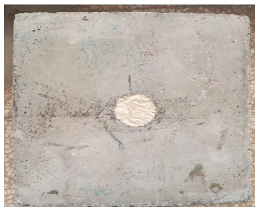
شکل ۵-۵) آب‌بندی انتهای حفره موجود در نمونه‌های مکعبی
