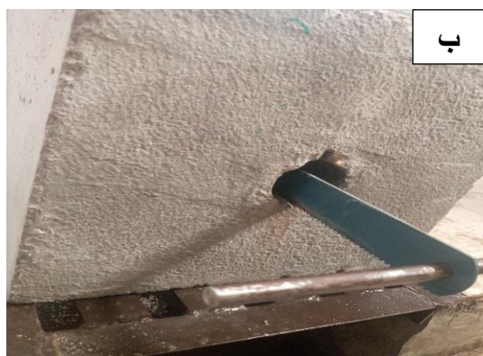
شکل ۲۲-۵) تهیه نمونه شکافدار، الف) شکاف از پیش موجود ب) روند ایجاد آن
