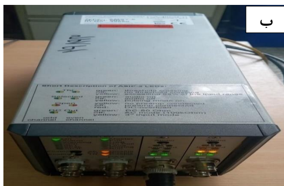
شکل ۴-۴) الف) ASIP-2 (پردازشگر سیگنال آکوستیک) [108]، ب) بدنه دستگاه
