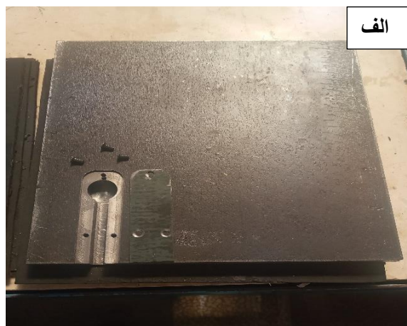
شکل ۵-۶ (الف) صفحه فلزی ماشین‌کاری شده، (ب) محفظه قرارگیری سنسور AE
