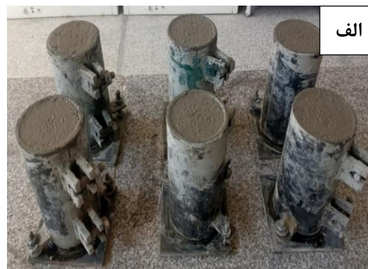
شکل ۴-۱ الف) بتن‌ریزی نمونه‌های استوانه‌ای، ب) قرار دادن نمونه‌ها در حوضچه آب
