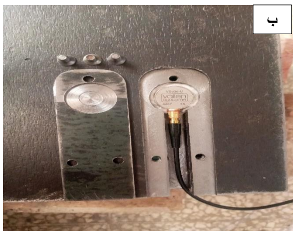
شکل ۵-۶ (الف) صفحه فلزی ماشین‌کاری شده، (ب) محفظه قرارگیری سنسور AE
