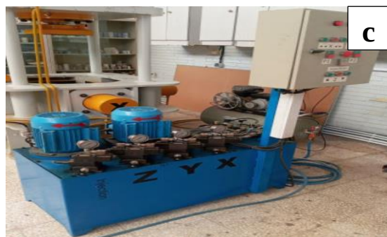
شکل ۳-۵ (a) محفظه اعمال فشار؛ (b) واحد تزریق؛ (c) واحد هیدرولیک؛ (d) واحد جمع‌آوری و نظارت بر داده‌ها
