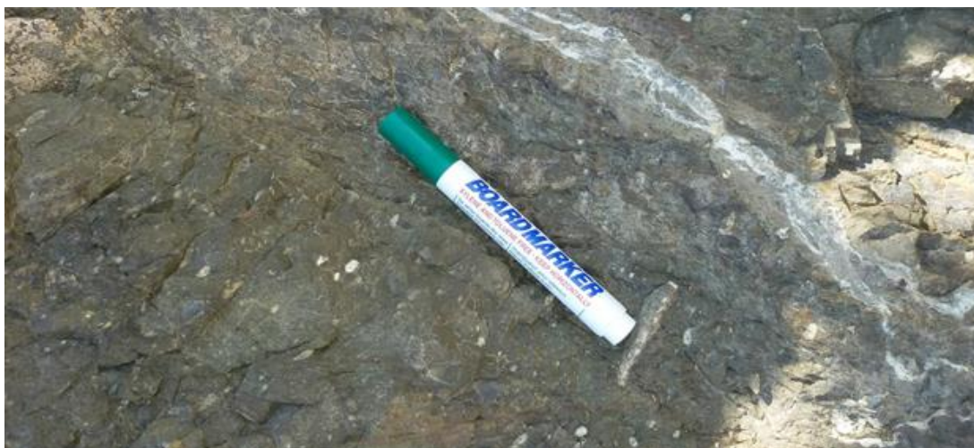
شکل ۳-۷: دگرسانی ژئولیتی که حفرات سنگ میزبان بازالت را پر کرده است و رگچه کلسیتی که شکستگی سنگ میزبان را پر کرده است.
