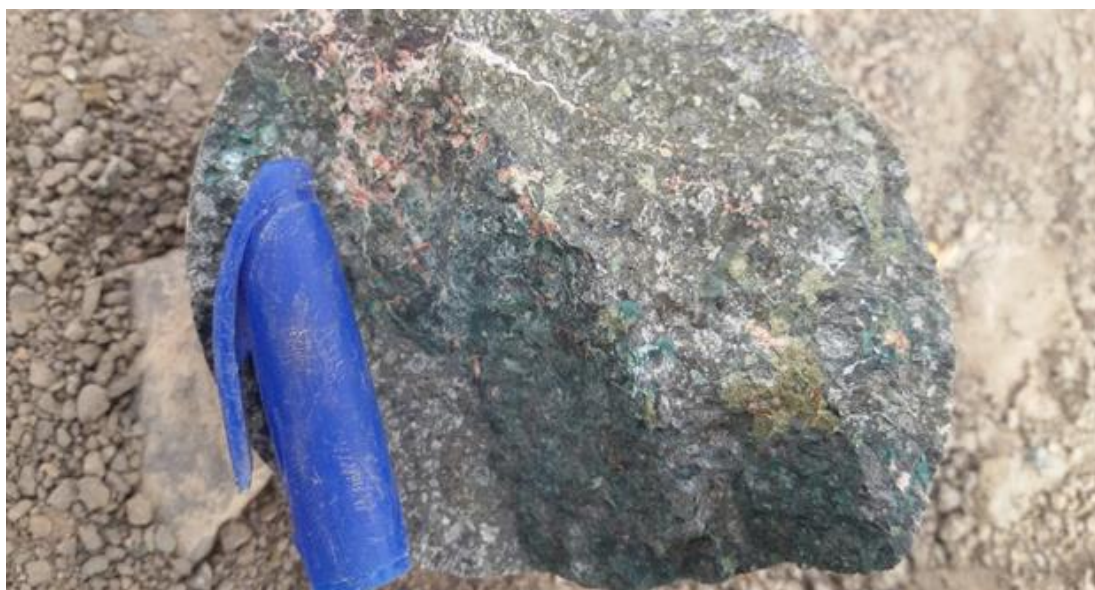
شکل ۳-۸: دگرسانی پروپیلیتیک در سنگ میزبان بازالتی که حاوی کانی های مس دار مانند مالاکیت است.
