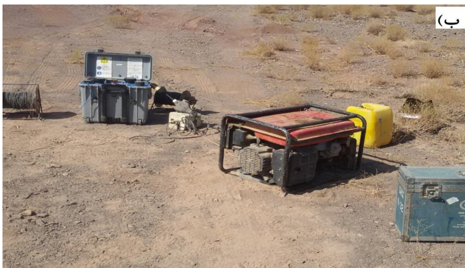
شکل ۴-۲: تجهیزات و ابزار ارسال جریان؛ الف) دستگاه فرستنده جریان TXIII (ب) ژنراتور، دستگاه فرستنده جریان و قرقره‌های کابل‌های انتقال جریان
