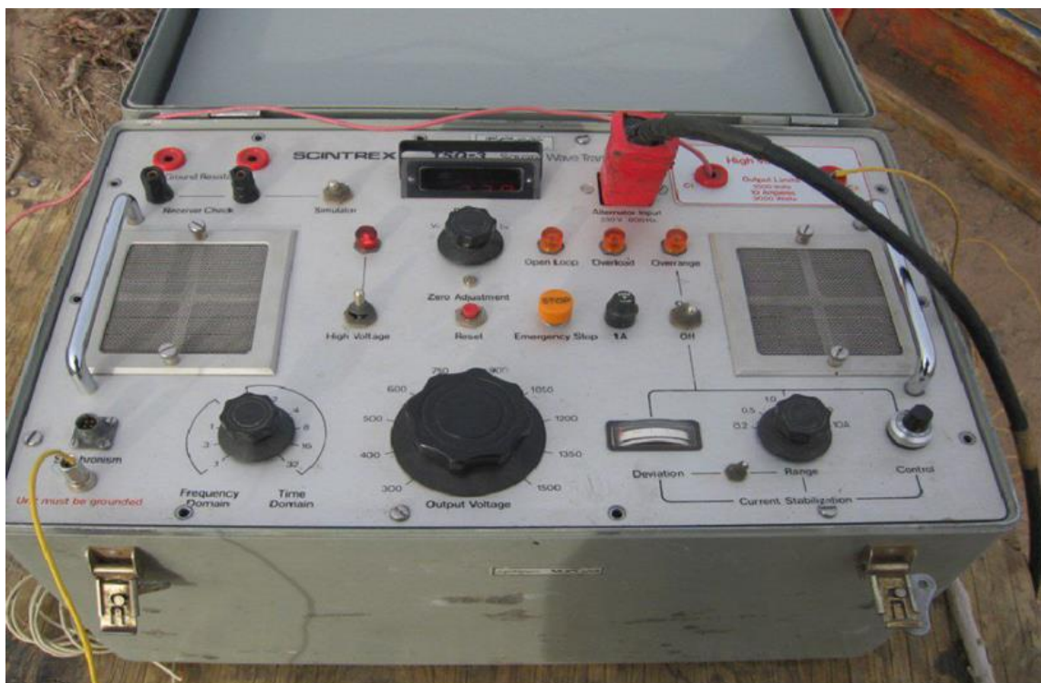
شکل ۴-۱۲: گیرنده IPRI2 ساخت شرکت Scintrex کانادا [۳۹]
