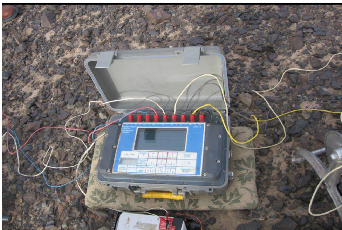
شکل ۴-۱۳: فرستنده TSQ-3 ساخت شرکت Scintrex کانادا [۳۹]
