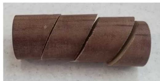
شکل (۳-۱۶) نمونه های تهیه شده با جهت داری ۴۵ درجه با (الف) یک شکستگی، (ب) دو شکستگی و (ج) سه شکستگی
