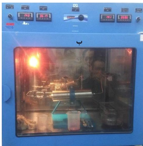
شکل (۳-۱۲) الف) شمای کلی دستگاه اندازه‌گیری تراوایی. ۱) پمپ تزریق آب ۲) پمپ روغن به منظور اعمال فشار محصورکننده ۳) آون و محفظه نگه‌دارنده مغزه، ب) قسمت درون آون
