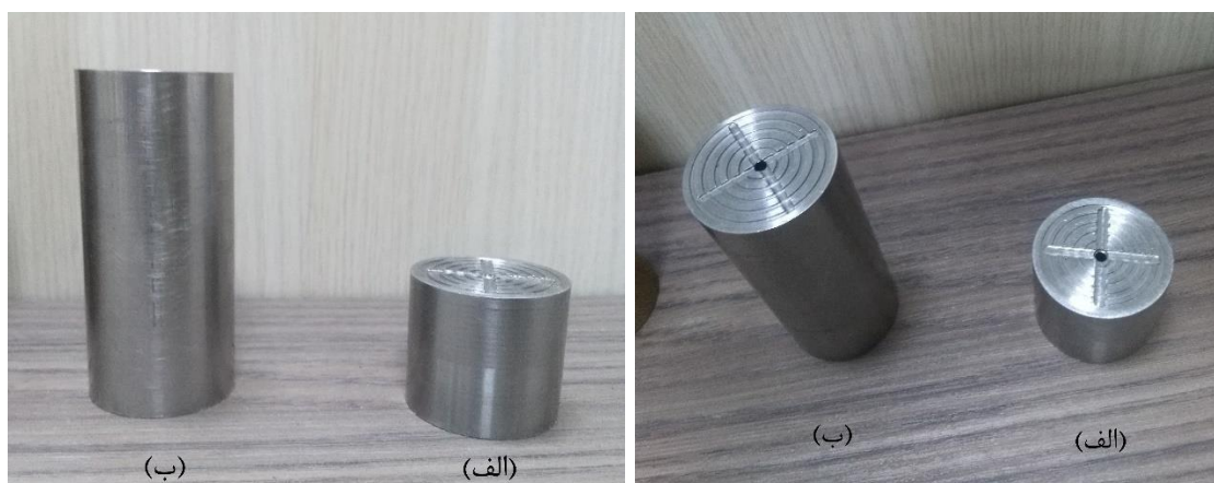
شکل (۳-۱) قطعات انتقال دهنده سیال به سر و ته نمونه در دستگاه اندازه‌گیری تراوایی
