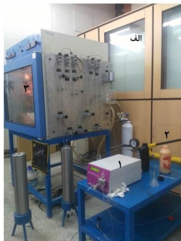
شکل (۳-۱۲) الف) شمای کلی دستگاه اندازه‌گیری تراوایی. ۱) پمپ تزریق آب ۲) پمپ روغن به منظور اعمال فشار محصورکننده ۳) آون و محفظه نگه‌دارنده مغزه، ب) قسمت درون آون
