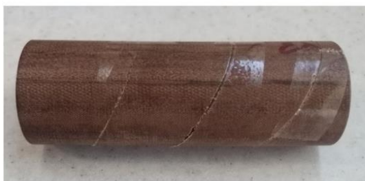
شکل (۳-۱۶) نمونه های تهیه شده با جهت داری ۴۵ درجه با (الف) یک شکستگی، (ب) دو شکستگی و (ج) سه شکستگی
