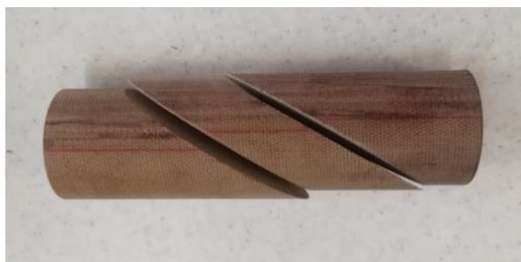
شکل (۳-۱۵) نمونه های تهیه شده با جهت داری ۶۰ درجه با (الف) یک شکستگی و (ب) دو شکستگی
