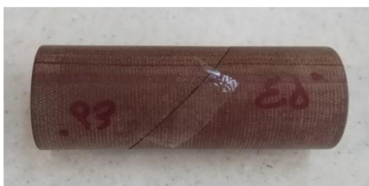
شکل (۳-۱۵) نمونه های تهیه شده با جهت داری ۶۰ درجه با (الف) یک شکستگی و (ب) دو شکستگی
