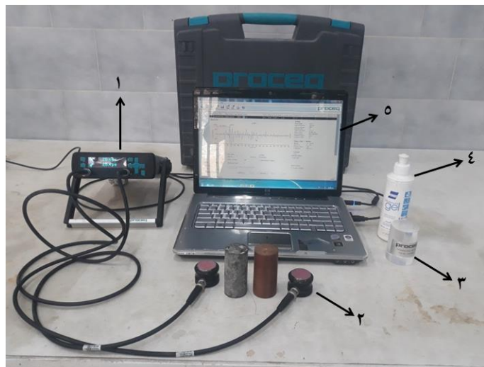
شکل (۳-۷) اجزای تشکیل‌دهنده دستگاه PUNDIT Lab+ : (۱) بدنه اصلی دستگاه (۲) مبدل (۳) میله کالیبراسیون (۴) ژل التراسونیک (۵) صفحه نمایش
