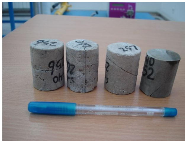
شکل (۱-۳) نمونه‌های مورد استفاده در آزمایش با شکستگی‌های مصنوعی تحت زوایای مشخص؛ مقدار زوایا به ترتیب از راست به چپ برابر است با ۳۰°، ۶۰°، صفر و ۹۰° (صانعیان، ۱۳۹۳)
