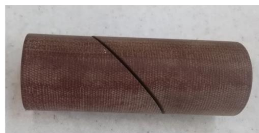
شکل (۳-۱۵) نمونه های تهیه شده با جهت داری ۶۰ درجه با (الف) یک شکستگی و (ب) دو شکستگی
