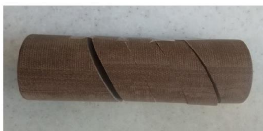
شکل (۳-۱۷) نمونه‌های تهیه شده با جهت‌داری ۳۰ درجه با (الف) یک شکستگی، (ب) دو شکستگی، (ج) سه شکستگی و (د) چهار شکستگی
