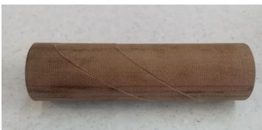
شکل (۳-۱۵) نمونه های تهیه شده با جهت داری ۶۰ درجه با (الف) یک شکستگی و (ب) دو شکستگی
