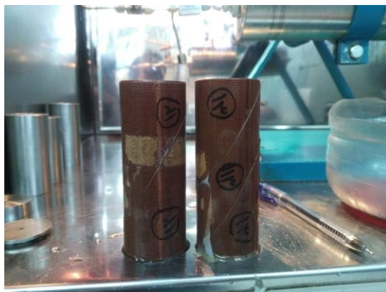
شکل (۱-۴) هندسه ناپیوستگی ها، الف: جهت داری صفر درجه، ب: جهت داری ۱۵ درجه، ج: جهت داری ۳۰ درجه، د: جهت داری ۴۵ درجه، هـ: جهت داری ۶۰ درجه
