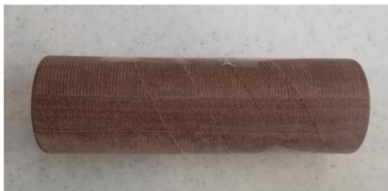
شکل (۳-۱۷) نمونه‌های تهیه شده با جهت‌داری ۳۰ درجه با (الف) یک شکستگی، (ب) دو شکستگی، (ج) سه شکستگی و (د) چهار شکستگی
