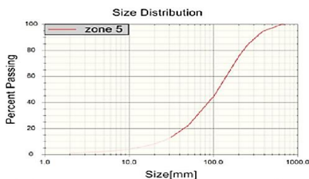
شکل ۳-۷: نمودار توزیع دانه‌بندی حاصل از خردایش (امیرشنوا و مومیوند، ۱۳۹۳)
