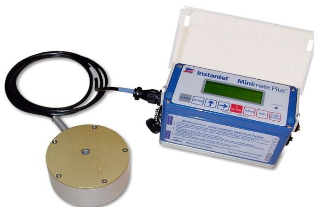
شکل ۴-۱۱: دستگاه ژئوفون مورد استفاده در برداشت‌ها
