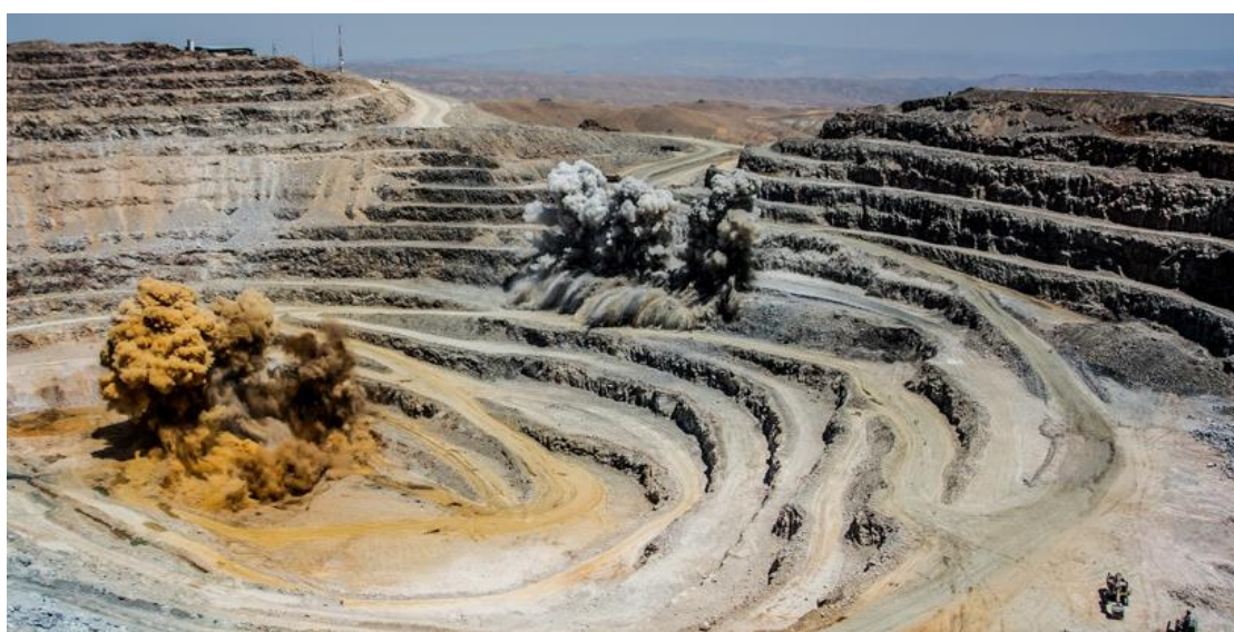
شکل ۱-۲: انفجار در سینه کارهای روباز در معدن انگوران
