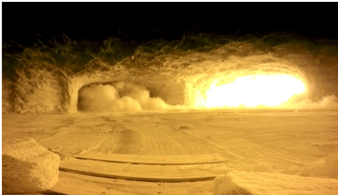
شکل ۲-۶: نمونه انفجار زیرزمینی در یک معدن اتاق و پایه
