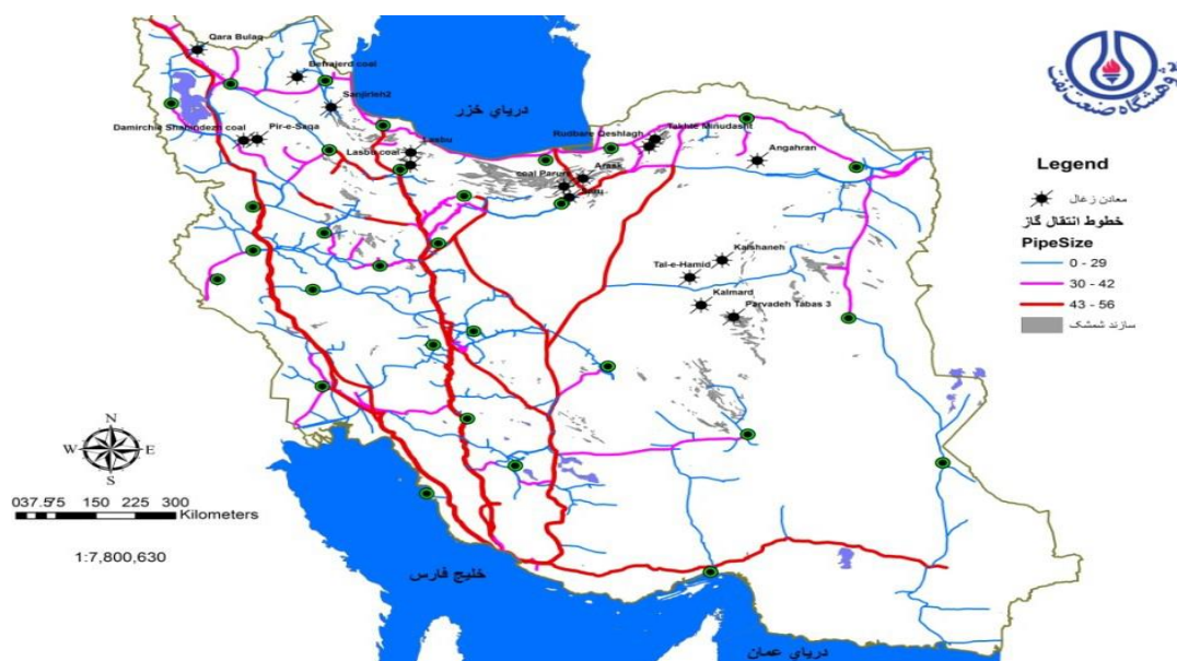
شکل ۲-۳- توزیع شبکه خطوط انتقال گاز و میزان مجاورت آن‌ها با ساختارهای زغال‌سنگ (عسکری، ۱۳۹۴)
