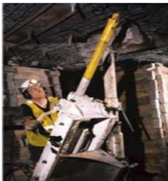
شکل ۲-۲- حفاری گمانه های تقاطعی (Ojha et al., 2011)
