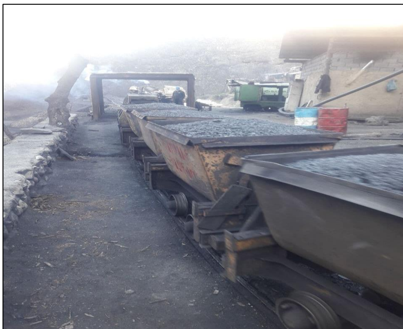
شکل ۲-۴ باربری زغال سنگ توسط واگن و لکوموتیو معدن زمستان یورت
