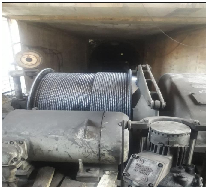
شکل ۲-۵ وینچ اکلن تونل ۳ معدن زمستان یورت
