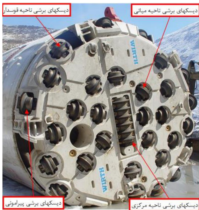
شکل ۲-۶: ناحیه‌بندی دیسک‌کاترها بر روی کاترهد بر حسب موقعیت نصب آن‌ها (فرخ، ۱۳۹۹)
