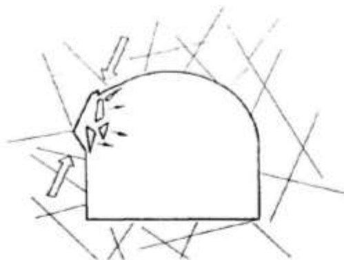
شکل ۸-۲- انفجار خودبه‌خودی کرنش پوسته پوسته شدن شدید معلول تمرکز تنش محلی سطحی [7]
