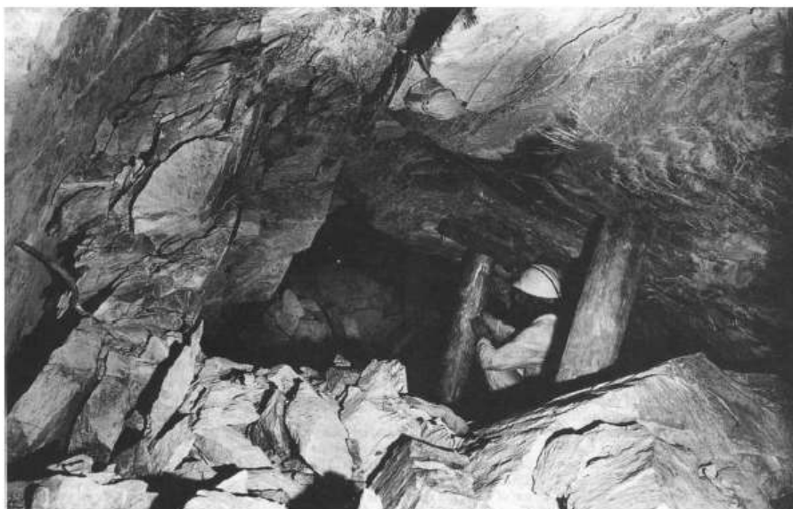
شکل ۲-۱۵- ریزش قوس دریافت باربری در کوارتزیت در عمق ۲۷۰۰ متری بعد از یک رویداد لرزه‌ای [7].
