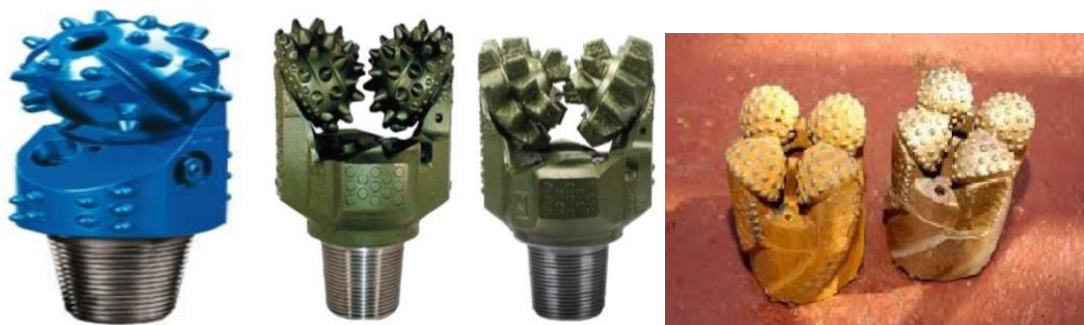
شکل ۲-۹ انواع مته‌های دورانی تک، دو و چهار مخروط (احمدی، ۱۳۹۵)
