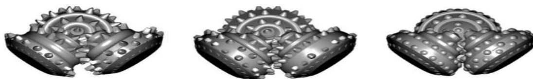
شکل ۲-۱۲ دندانه مته‌ای دکمه‌ای از سمت راست برای سازندهای سخت، نیمه‌سخت و نرم (Fasheloum, 1997)
