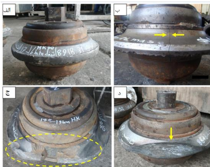
شکل ۲-۴: متداول ترین نوع سایش دیسک کاتر (الف) سایش نرمال (ب) ترک خوردگی حلقه (ج) شکستن حلقه (د) ساییدگی یک طرفه (عکس مرتضی کرمی در تونل انتقال آب اوما اوپا) (Karami et al., 2021)
