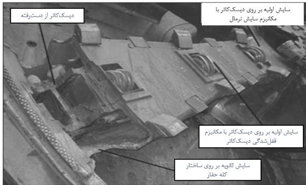
شکل ۱-۲: سایش بیش از حد بر روی کله حفار یک TBM (Nilsen et al., 2007).
