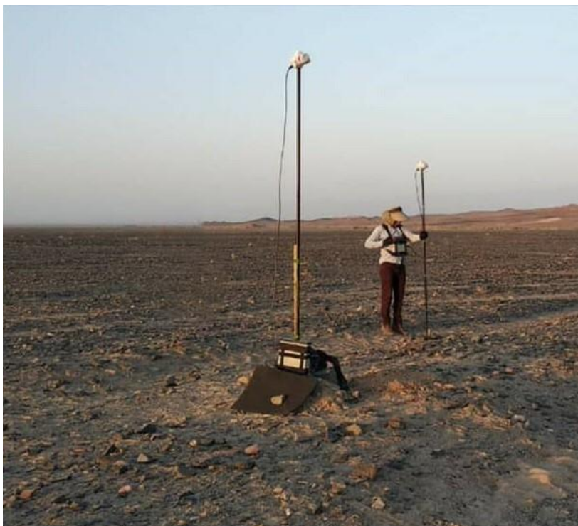
شکل (۲-۴): عملیات برداشت مغناطیس‌سنجی محدوده مورد مطالعه.
