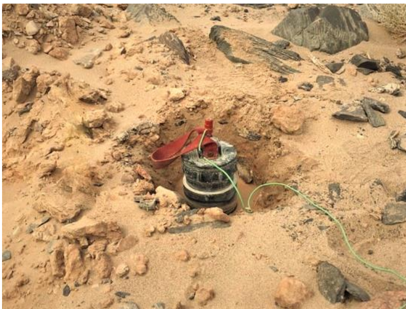
شکل (۴-۱۸): تصویری از الکتروود غیره پلاریزه پتانسیل بر روی یکی از نقاط برداشت شده در محدوده مورد مطالعه.
