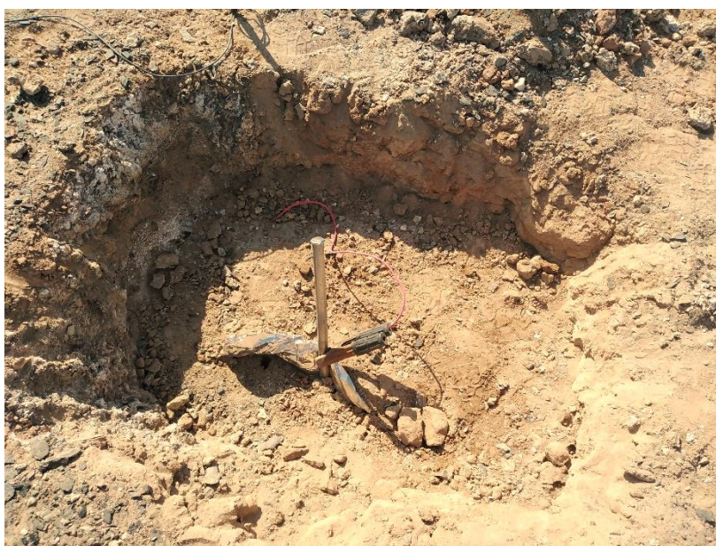
شکل (۴-۱۹): شیوه قرار دادن فویل آلومینیومی در محل‌هایی انتقال جریان به درون زمین در منطقه مورد مطالعه.
