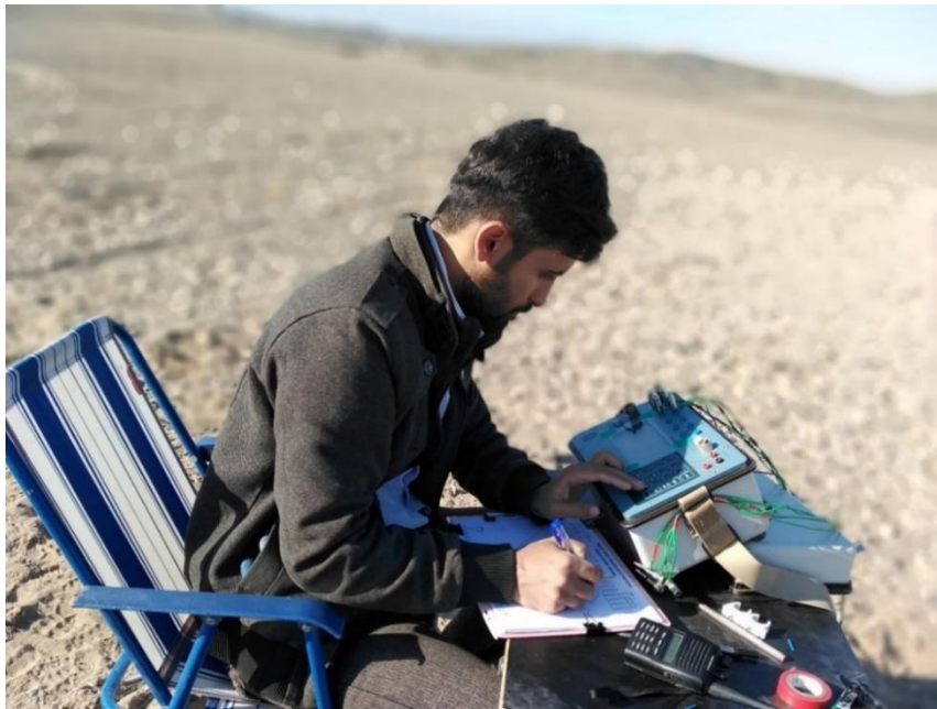
شکل (۴-۱۷): اجراء عملیات صحرائی برداشت داده های مقاومت ویژه و IP در محدوده مورد مطالعه.
