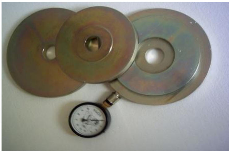
شکل (۳-۶) نمونه‌ای از بارسنج استفاده شده در تونل البرز
