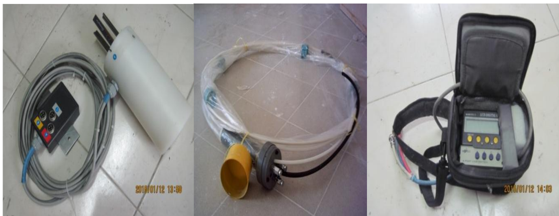
شکل (۳-۵) اجزای تشکیل دهنده کشیدگی سنج گمانه‌ای و چندنقطه‌ای
