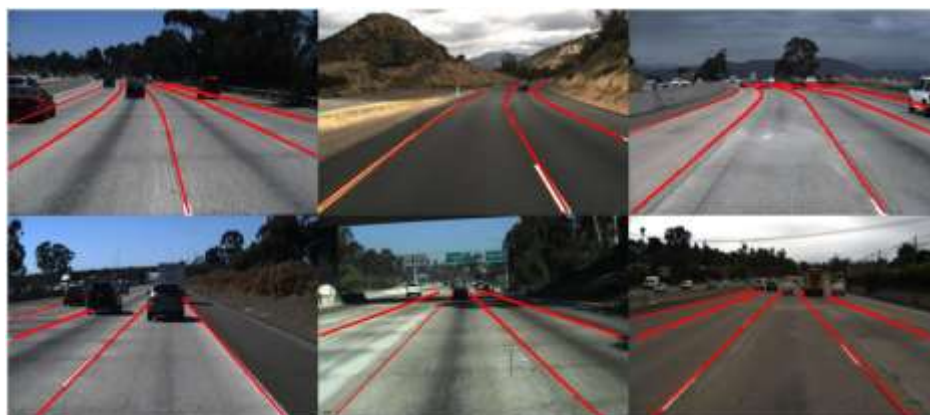
شکل ۵-۱۲: نمونه خروجی شناسایی خطوط با استفاده از ResNet50
