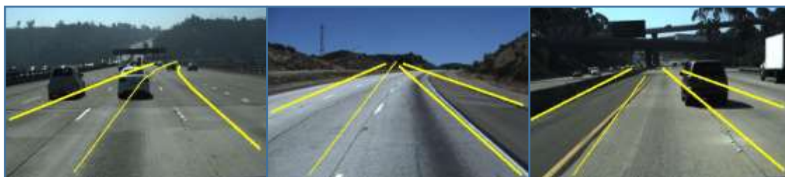
شکل ۵-۱۱: تعدادی از خروجی های با عمل کرد نامطلوب در شناسایی خطوط در روش پیشنهادی مبتنی بر یادگیری عمیق
