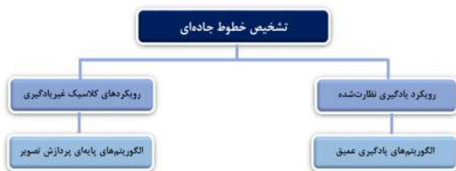
شکل ۱-۲: دیاگرام کلی تشخیص خطوط جاده‌ای
