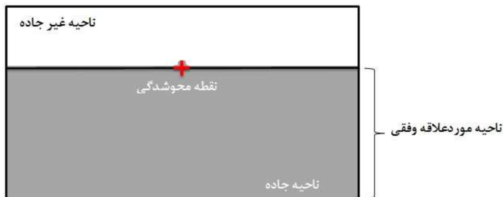
شکل ۲- ۹: تعیین ناحیه مورد علاقه توسط نقطه محوشدگی [۲۱]
