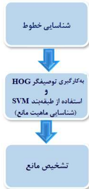
شکل ۱-۴: دیاگرام کلی فرایند تشخیص خطوط جاده و موانع
