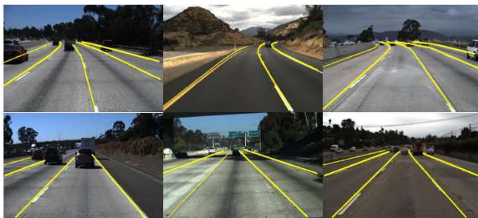
شکل ۵-۱۰: عمل کرد مطلوب شناسایی خطوط از به کارگیری شبکه عمیق مولد رقابتی نیمه نظارتی
