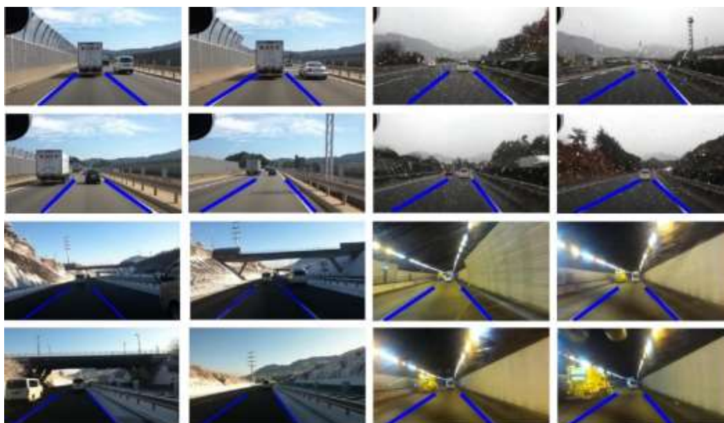
شکل ۵-۵: تعدادی از نتایج آزمایشات روش پیشنهادی اول بر روی پایگاه داده‌ها IROADS با خروجی مطلوب
