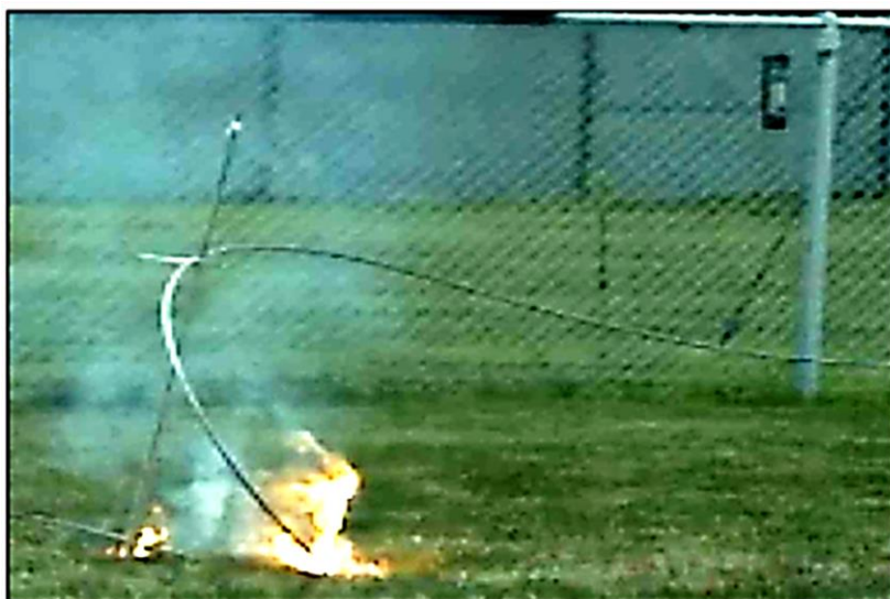
شکل (۲-۵): وقوع HIF در سطح چمن [۳۸]
