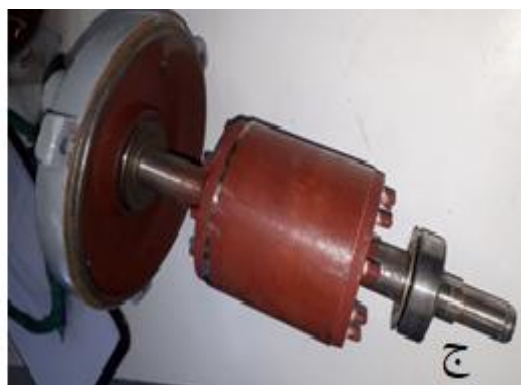
شکل ۳-۸: موتور القایی مورد مطالعه، الف) ساختار کلی موتور، ب) اجزا اصلی موتور، ج) روتور قفس سنجایی، د) استاتور با
