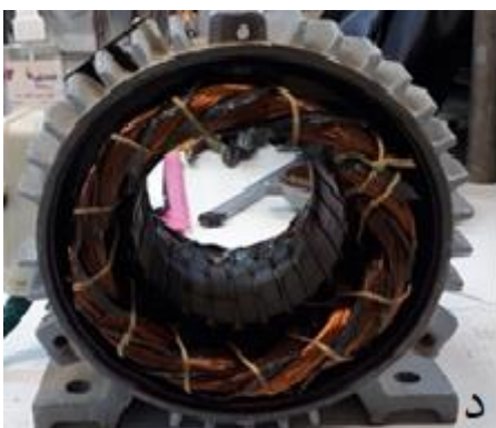
شکل ۳-۸: موتور القایی مورد مطالعه، الف) ساختار کلی موتور، ب) اجزا اصلی موتور، ج) روتور قفس سنجایی، د) استاتور با
