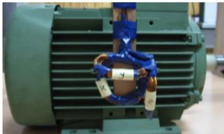
شکل ۲-۲۲: حسگرهای سیم‌پیچ اندازه‌گیر میدان اطراف موتور القایی [۱۴]
