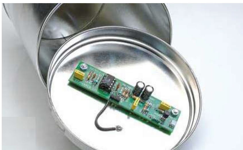
شکل ۳-۱۳: استفاده از قوطی فلزی برای محافظت از نور مرئی و اغتشاشات خارجی [۹]
