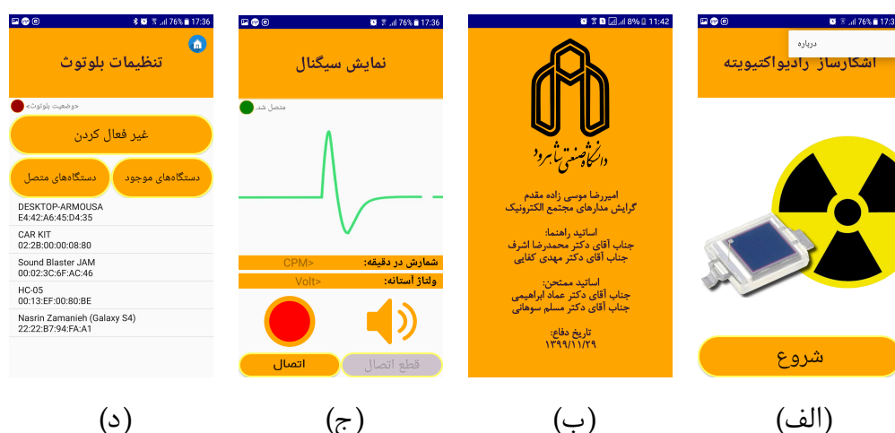
شکل ۴-۲۵: (الف) صفحه ابتدایی نرم‌افزار آشکارساز رادیواکتیویته، (ب) صفحه درباره ما نرم‌افزار آشکارساز رادیواکتیویته، (ج) صفحه نمایش داده‌ها نرم‌افزار آشکارساز رادیواکتیویته، (د) صفحه تنظیمات بلوتوث نرم‌افزار آشکارساز رادیواکتیویته
