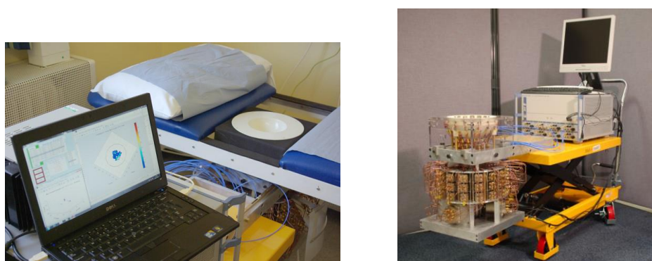
شکل (۲-۱۱)-نمای کلی از سیستم تصویربرداری مرجع [۳] (الف) سیستم تست شده در آزمایشگاه. (ب) سیستم ساخته شده برای تست‌های کلینیکی
