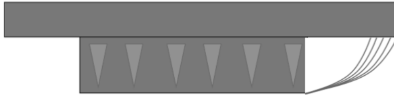
شکل (۱۲-۳) - شار نشتی بین یک بخش کوچک آهنربا و هسته روتور
