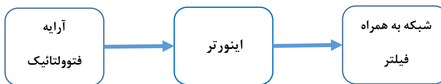
شکل ۴-۱: بلوک دیاگرام عملکرد اینورترهای متصل به شبکه.
