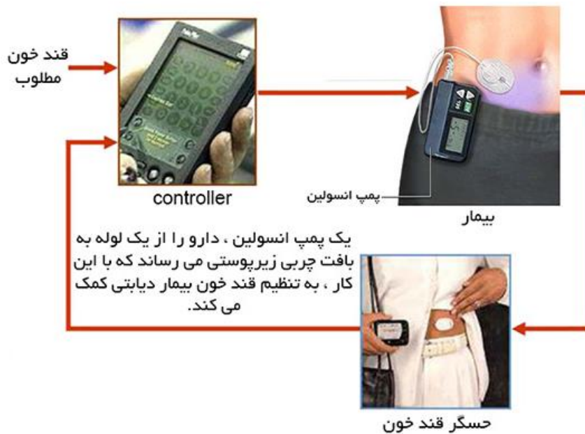
شکل ۴-۱: کنترل حلقه بسته بیماری دیابت با عملگر تزریق پمپ
