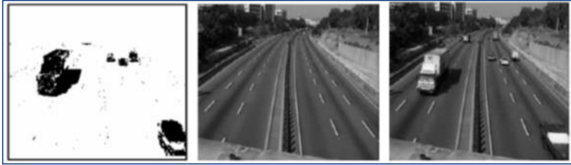
الف: قاب ورودی ب: پس زمینه ج: اجسام متحرک شناسایی شده
