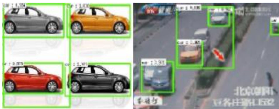
شکل ۲-۲۵: آشکارسازی محدوده خودروها توسط روش [۷۰]
