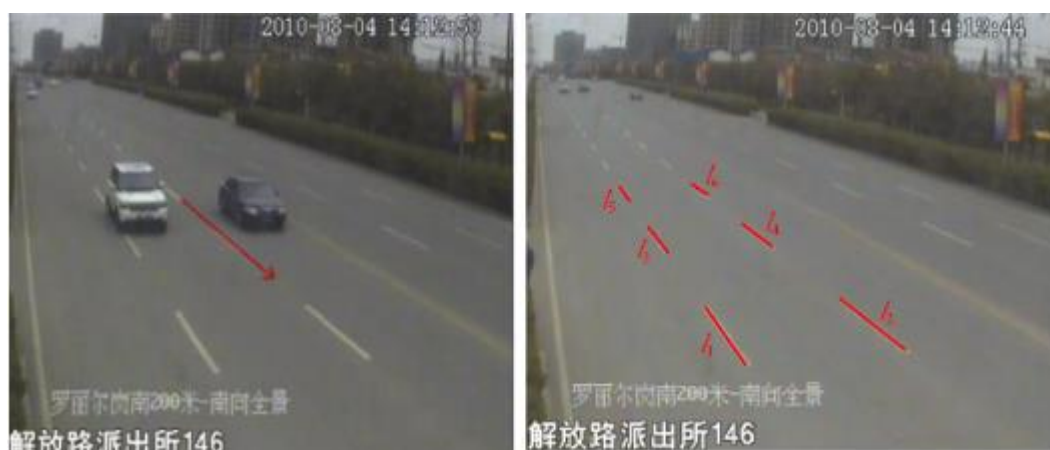
شکل ۲-۱۵: نمایش راستای حرکت خودروها و طول خطوط جاده در روش یانگ [۴۶]
