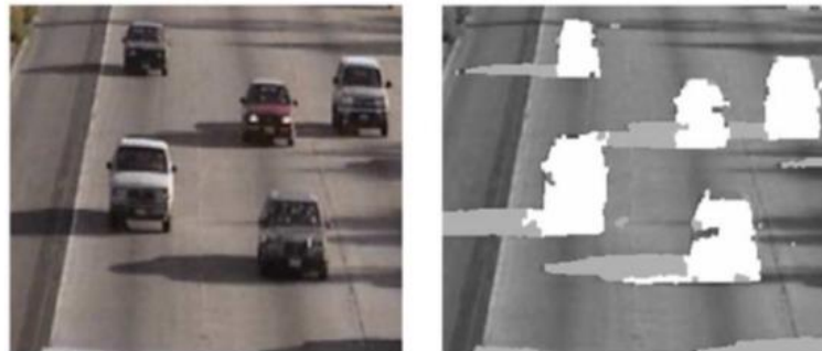
شکل ۵-۲: نتایج روش [۳۲] در تفکیک خودرو، جاده و سایه
