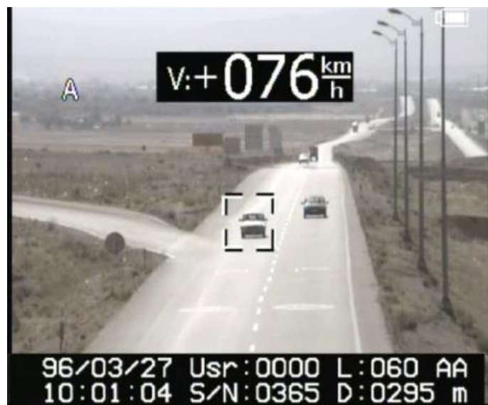
شکل ۱-۱: نمونه‌ای از تصویر دریافتی از دوربین‌های لیزری ناجا برای اندازه‌گیری سرعت
