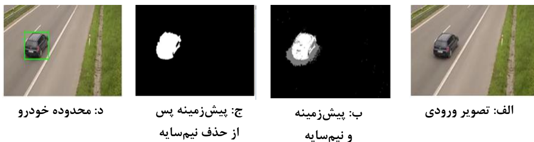
شکل ۳-۴: شناسایی خودروی متحرک به‌عنوان پیش‌زمینه
