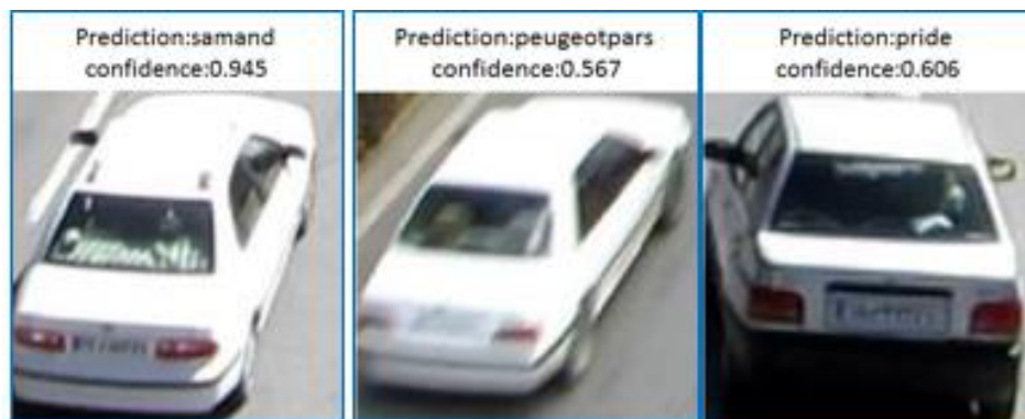
شکل ۳-۱۹: نتایج VGG ۱۹ در شناسایی نوع دقیق خودرو
