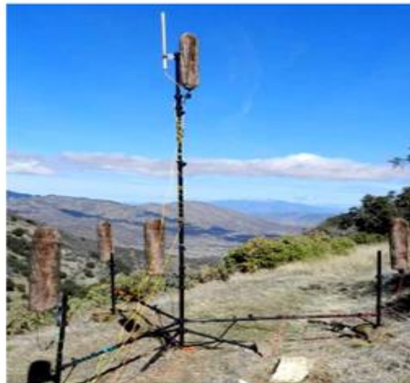
شکل (۳-۲): تصویر سیستم تشخیص ارتعاش هوا (ASAD) [۲].
