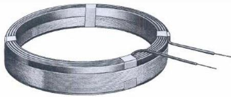
شکل(۳-۵): نمایش یک واحد به شکل دیسک از سیم پیچی نوع دیسکی [۶۳]
