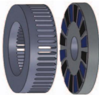
شکل (۲-۱۷): نمایی از ساختار یک طرفه ماشین AFPM با استاتور شیاردار و روتور با آهن‌رباهای سطحی [۵]
