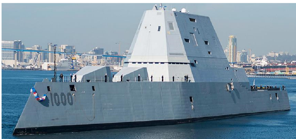
شکل (۶-۱) مثالی از تغییر شکل مورد استفاده در ناو DD-X، هیچگونه زاویه قائم استفاده نشده است.
