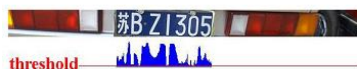
شکل ۲-۴- استخراج ناحیه پلاک در جهت افقی در مرجع [۳]
