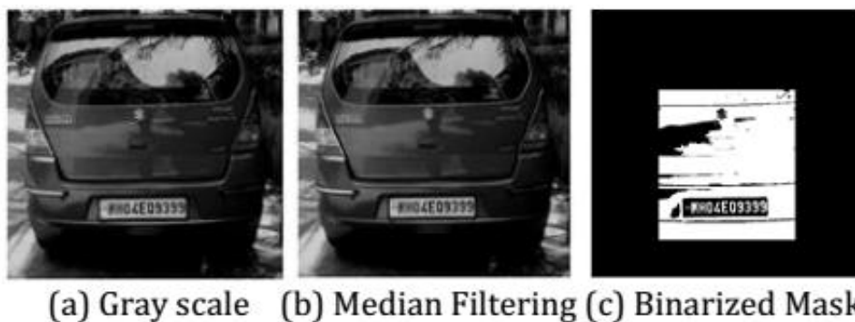
شکل ۲-۱۰-۱- مراحل انجام شده در بخش پیش پردازش در مرجع [۶]
