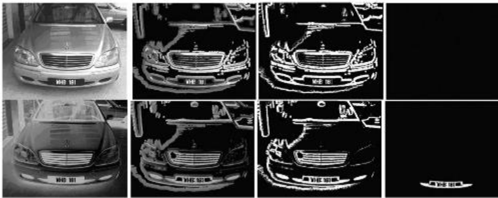
شکل ۲-۱۴ در ردیف اول پلاک سیاه با کارکتر سفید پیدا نشده است در ردیف دوم با معکوس کردن تصویر پلاک مکان یابی شده است [۱۲]
