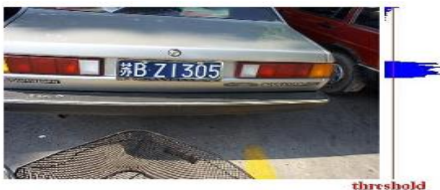
شکل ۲-۳- استخراج ناحیه پلاک در حالت عمودی در مرجع [۳]
