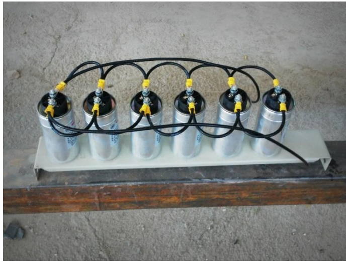
شکل (۵-۵): بانک خازنی ۳۰۰ میکروفارادی
