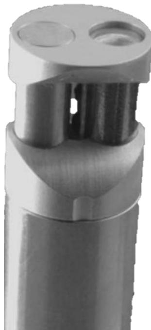
شکل ۲-۸: نمایی از پروب p-u اندازه‌گیری شدت صوت ساخت شرکت [۵۹] Microflown
