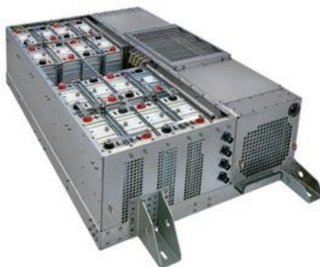
شکل (۱-۳) ذخیره‌ساز ابرخازن نصب شده روی قطار ساخته شده توسط شرکت BOMBARDIER [43]
