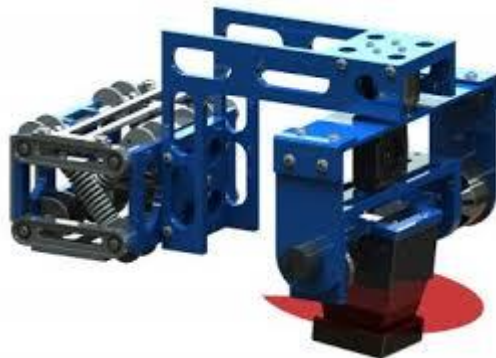
شکل (۹-۱): پایدارکننده ژيروسکوپی فعال
