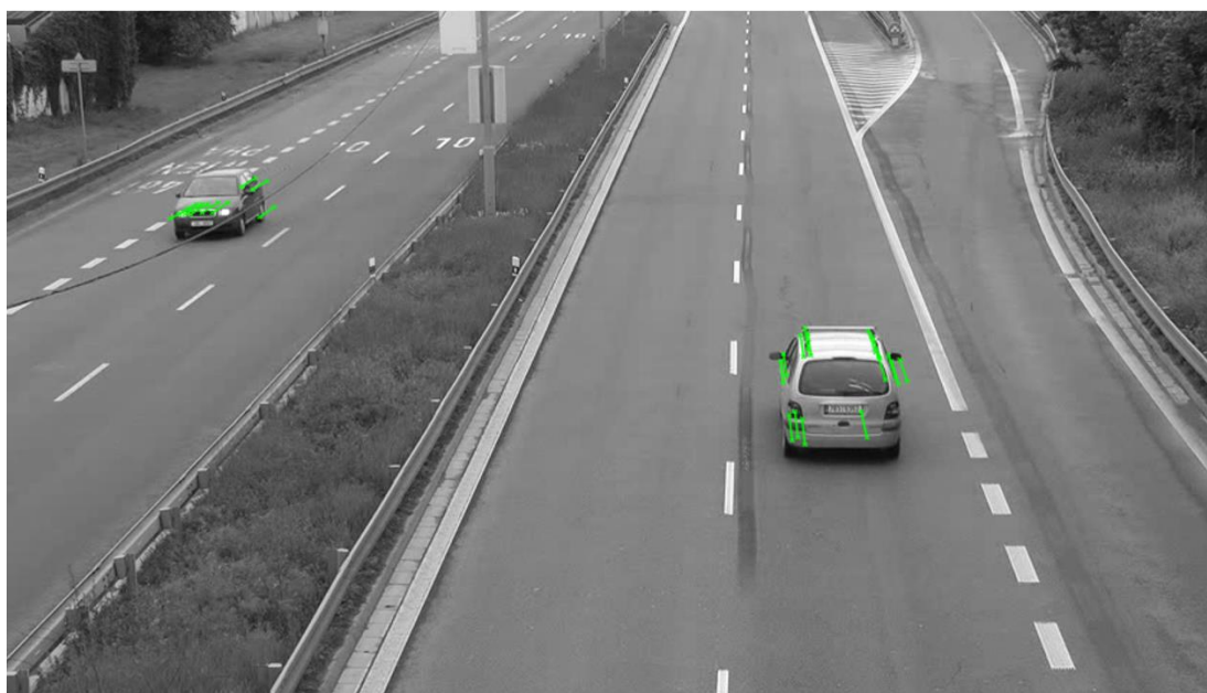
شکل ۳-۱۰: نقاط ویژگی شناسایی و ردیابی شده برای بدست آوردن اولین نقطه محوشوندگی.
