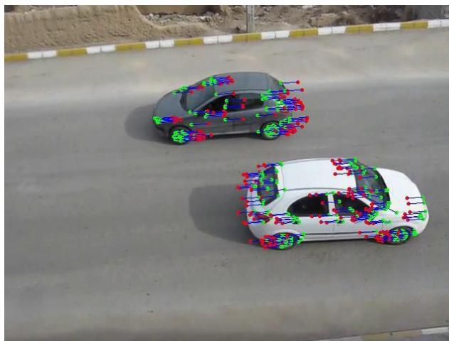
شکل ۷-۳: نتیجه اجرای الگوریتم شار نوری به کمک مجموعه نقاط پراکنده بین دو قاب متوالی: نقاط قرمز مربوط به قاب قبلی و نقاط سبز مربوط به قاب بعد فعلی است
