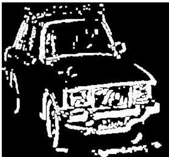
شکل ۴-۶: نتیجه نهایی الگوریتم: ROI در برگرفته خودروی عبوری که به درستی به دست آمده است.
