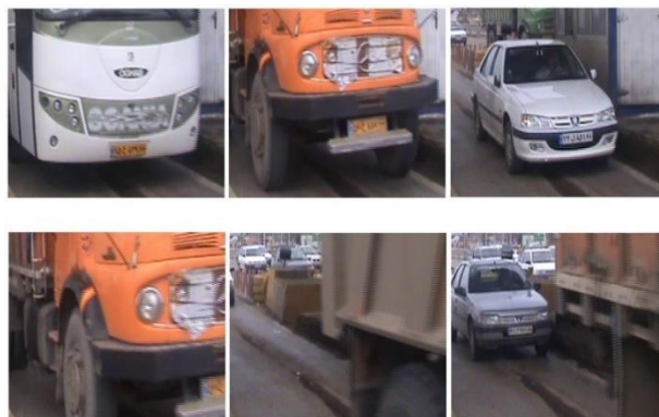
شکل ۴-۱۱: نمونه‌هایی از تصاویر جدا شده از قاب‌های ویدئو: در ردیف بالا تصاویر خودروها و در ردیف پایین تصاویر غیر خودروها قرار دارند.
