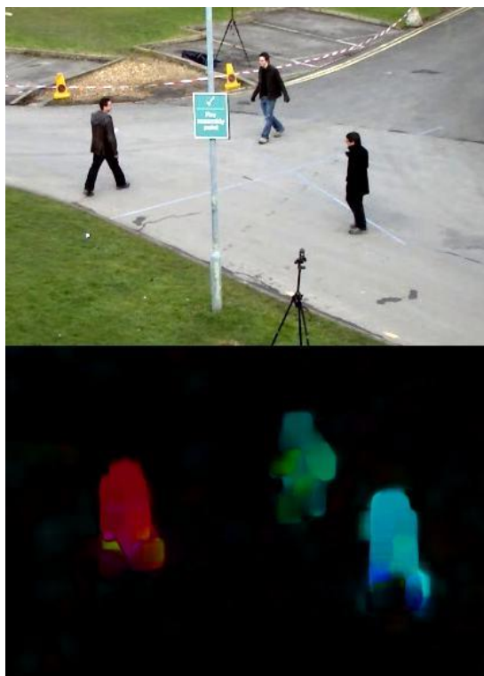
شکل ۸-۳: نتیجه اجرای الگوریتم شار نوری چگال: تمام نقاط دارای حرکت بین دو قاب متوالی دنبال می‌شوند.
