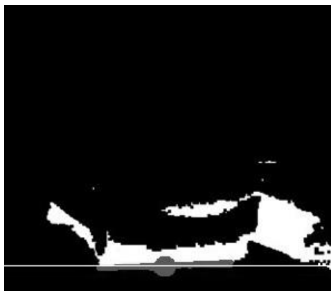
شکل ۴-۱۴: تصویر سایه حاصل از آستانه‌گذاری تصویر سطح خاکستری: پایین‌ترین قطعه خط افقی و مرکز آن، با رنگ خاکستری و مرز پایین ناحیه جلوی خودرو با رنگ سفید نشان داده شده‌اند.
