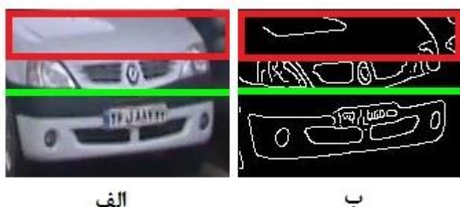
شکل ۴-۱۹: الف) تصویر ناحیه جلوی خودرو (ب) لبه‌یابی شده تصویر الف : ناحیه مورد نظر برای انجام عملیات تشخیص رنگ با یک مستطیل قرمز رنگ و خط نیمه تصویر با خطی سبز رنگ نشان داده شده‌اند.
