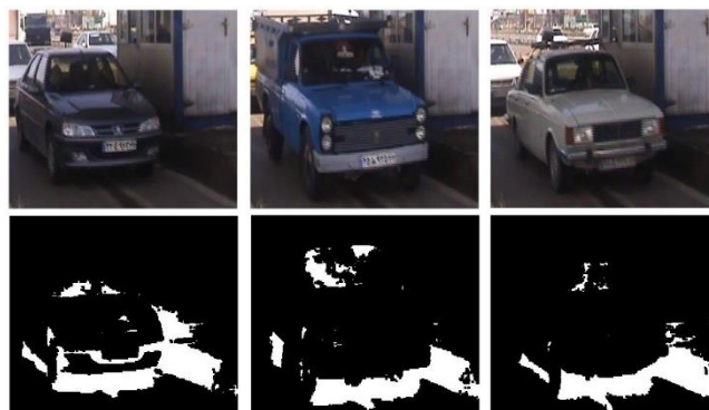
شکل ۴-۱: سه نمونه تصویر که در آن‌ها جداسازی سایه زیر خودرو به صورت یک ناحیه مستطیلی مجزا ممکن نیست : در ردیف پایین تصاویر سایه متناظر با تصاویر ردیف بالا نشان داده شده‌اند.
