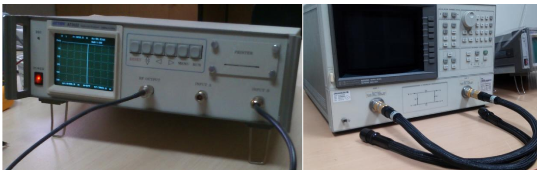
شکل (۳-۱) نمونه‌هایی از تحلیل‌گر شبکه، الف) مدل 8720C ب) مدل AT3022
