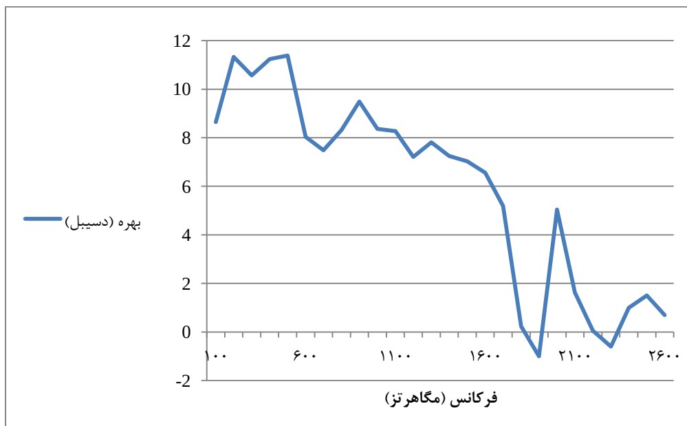
شکل (۵-۱۴) بهره توان اندازه‌گیری شده برای تقویت‌کننده پیشنهادی
