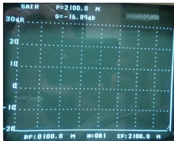
شکل (پ-۱) S21 اندازه گیری شده برای دومین نمونه ساخته شده از تقویت کننده پیشنهادی
