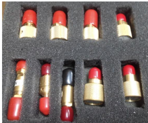
شکل (۹-۳) استانداردهای SOLT در جعبه کالیبراسیون 85052D محصول شرکت Agilent
