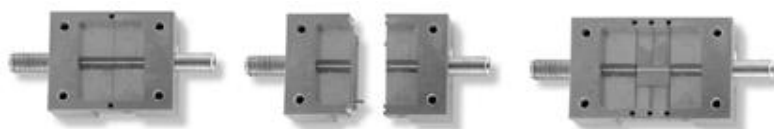
شکل (۱۰-۳) نمونه‌ای از استانداردهای TRL با افزاره‌های خط ریزنوار (مرجع: [۲۴])
