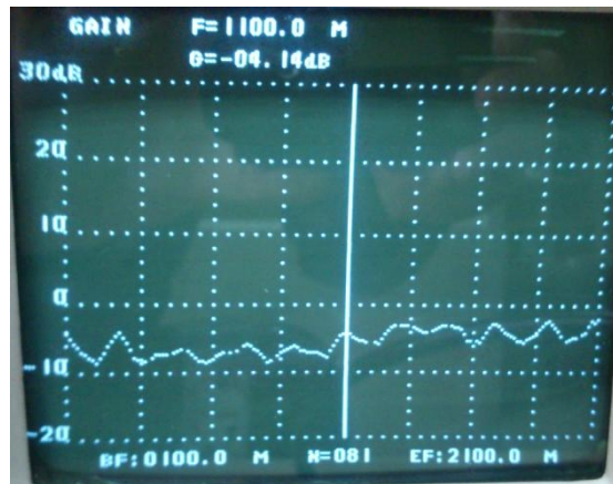
شکل (پ-۱) S21 اندازه گیری شده برای دومین نمونه ساخته شده از تقویت کننده پیشنهادی
