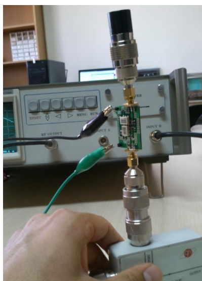
شکل (۴-۲۲) اندازه‌گیری ضریب بازتاب تقویت‌کننده با تحلیل‌گر شبکه
