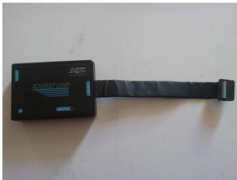
شکل (۳-۱): JTAG جهت ارتباط کامپیوتر با پردازنده DSP
