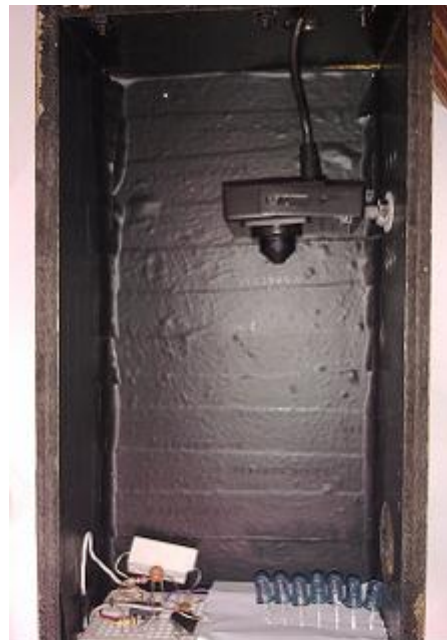
شکل ۲-۴. نمای داخلی دستگاه برای تهیه تصاویر رگ انگشت
