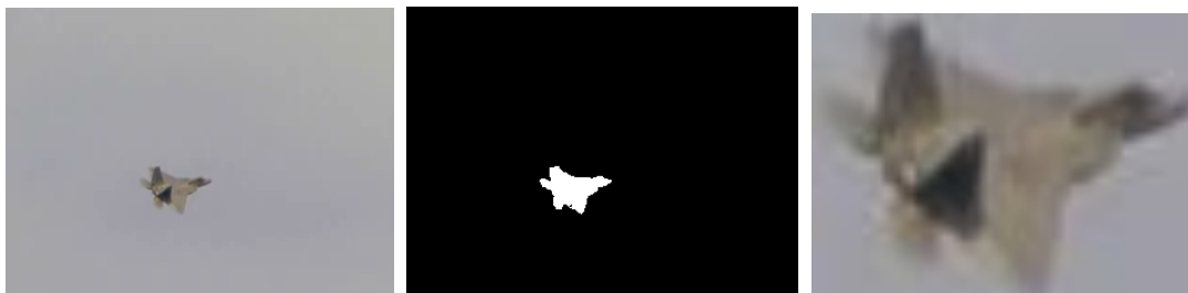
شکل (۴-۵). به ترتیب از چپ به راست، اولین فریم از فیلم، تصویر باینری معادل آن که خروجی ماشین بردار پشتیبان است و قسمتی از تصویر که به عنوان هدف تشخیص داده شد.
