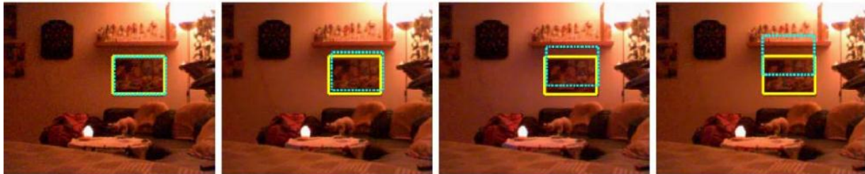
شکل (۲-۴) نمایش مشکل لغزش در بروز رسانی قالب [۵]
