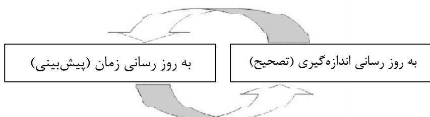
شکل (۲-۵): عملکرد کلی فیلتر کالمن [۸]
