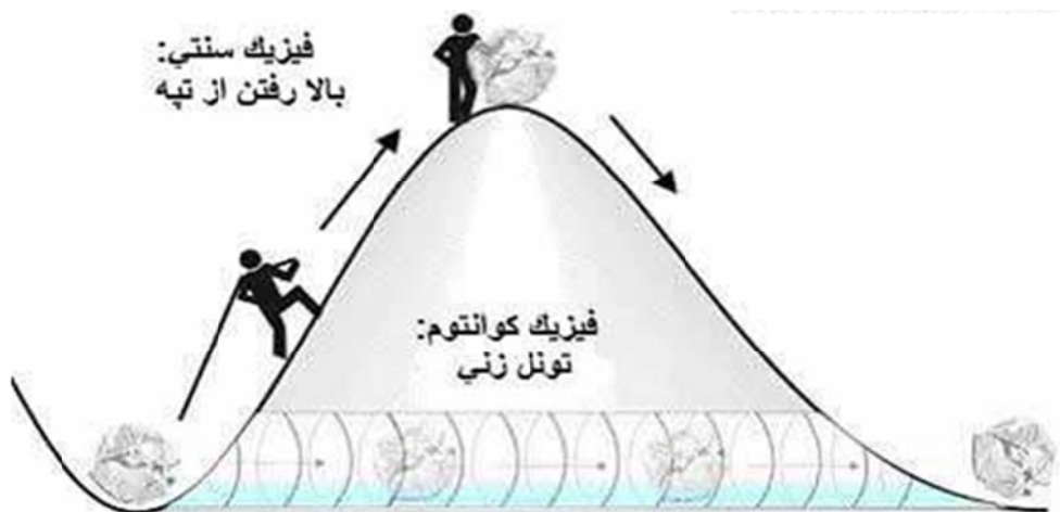
شکل ۴.۱: شماتیکی از پدیده تونل زنی
