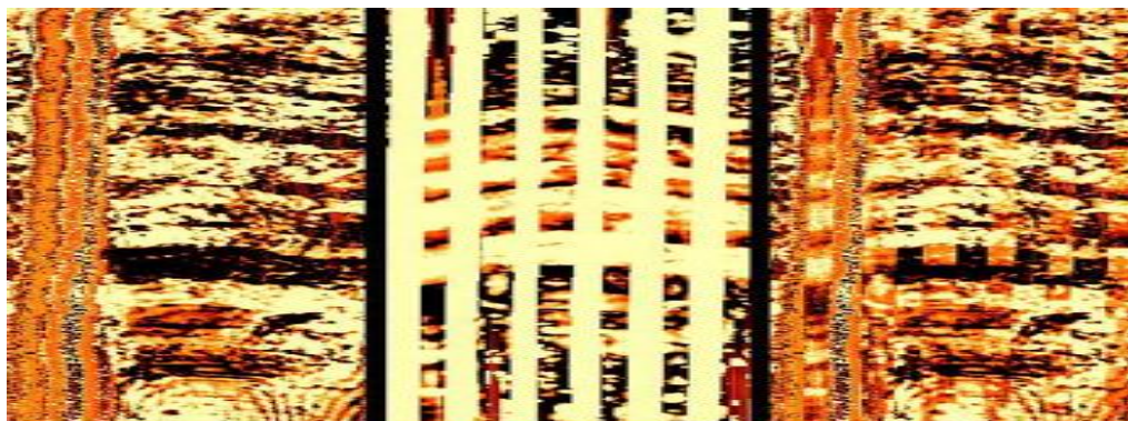
شکل ۳-۲ تصویر سمت چپ CBIL و وسط Earth Imager و سمت راست تصویر حاصل از الگوریتم ادغام [۵]
