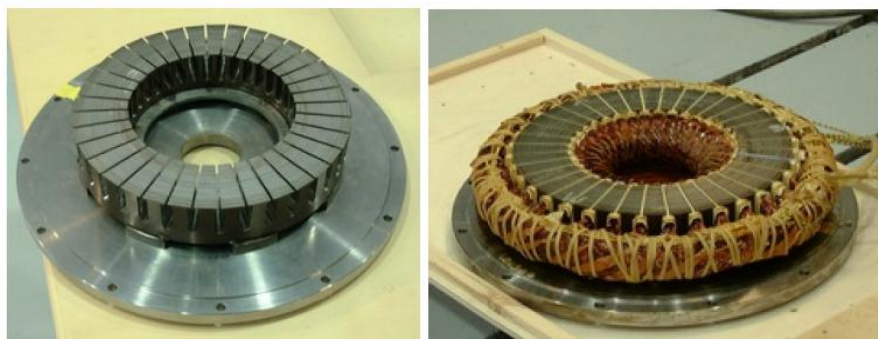
شکل ۲-۲۱- یکی از استاتورهای ماشین شار محوری نوع AFIR-S قبل و بعد از سیم‌پیچی [۸]
