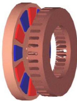
شکل ۲-۴- ساختار ماشین شیاردار شار محوری آهن‌ربای دائم یک روتور- یک استاتور [۸]
