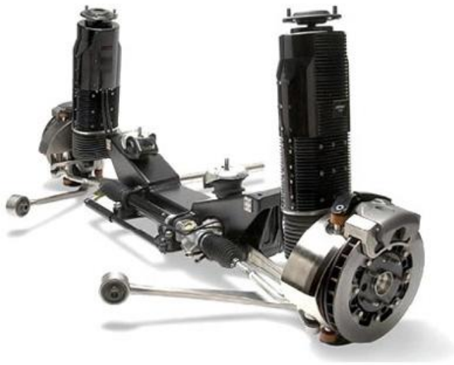
شکل 2-8 : عملگر LEM ساخت شرکت Bose [10].
