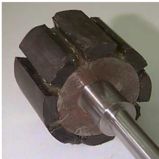
شکل ۷-۲: آهنربای مغناطیس دائم روی سطح روتور آهنی
